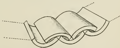
199. — Lits de tuiles emboîtées, d'après Choisy, op. cit. , fig. 78.
